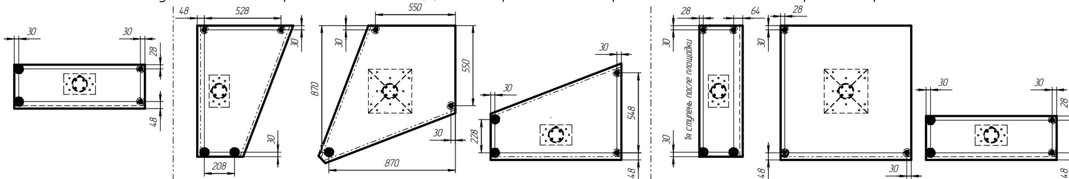
Разметка поручня под крепление к стойкам перил (глухое отверстие  $\phi 7 \times 30$  мм)
